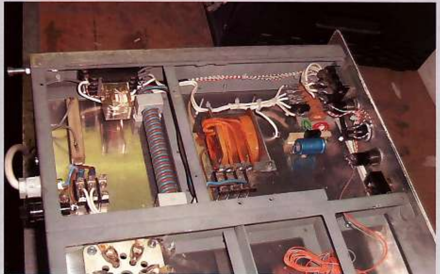
Onderzijde, met gemonteerde gloeistroom-choke en onderaan de buisvoet.
